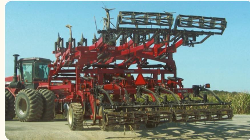
■ При рабочей ширине до 6,70 м крылья модели 9800 складываются полностью. Габаритная ширина при транспортировке и хранении данного оборудования - всего 3,81 м.
