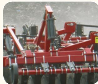
**Независимо управляемая гидравлическая дисковая батарея.** Система управления позволяет Вам устанавливать требуемое заглубление дисков, что называется, "на ходу", а установленные под углом к направлению движения дисковые батареи обеспечивают максимальное размельчение остатков.
