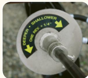
**Узел контроля глубины с точной настройкой.** Узел контроля глубины с точной настройкой является стандартом для культиваторов Salford. Он гарантирует равномерную глубину обработки, благодаря управлению штоками цилиндров из "одной точки" агрегата.
