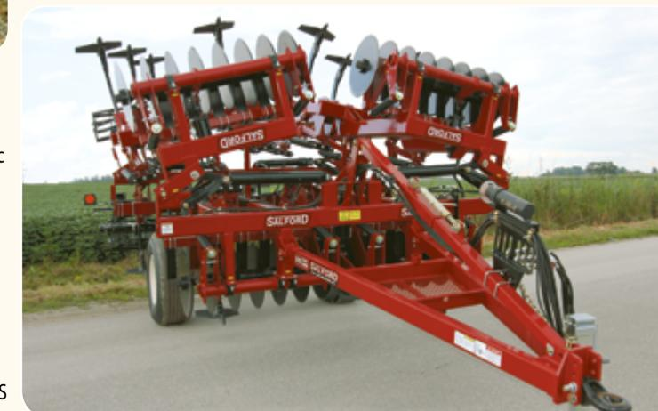
■ Складные крылья позволяют уменьшить транспортную ширину до 3,81м.
