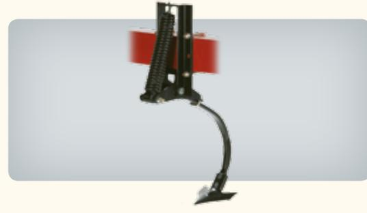
Культиваторы Salford со стойкой C-Shank производятся с 6-ти рядными рамами для расстановки рабочих органов с междурядьем в 17.8 см. C-образные стойки дают клиренс в 66 см для уверенного пропуска пожнивных остатков. Пружинный блок стойки обеспечивает противодавление в интервале 90 - 120 кг и имеет в шарнирном соединении сменную нейлоновую втулку, что освобождает от необходимости смазки этого узла.
