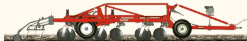
Осенняя обработка: максимальная глубина обработки - 12.7 см
