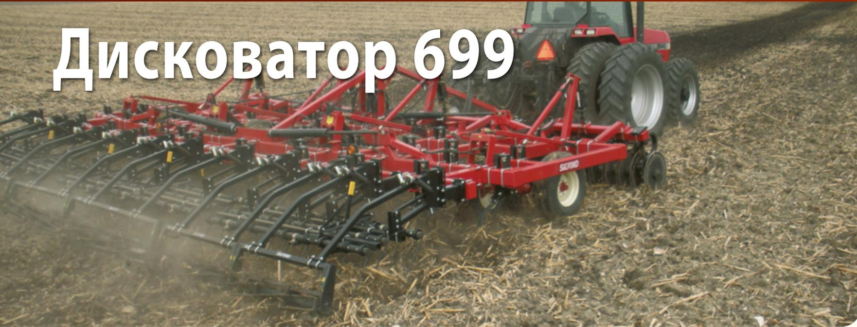
**Дисковый культиватор Salford серии 699 является незаменимым орудием для предпосевной подготовки на неровных полях, где требуется выравнивание с одновременным уничтожением сорняков.**
