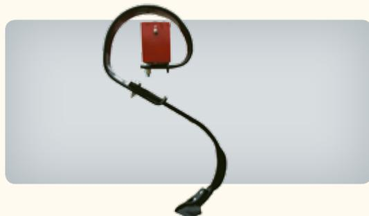
Культиваторы Salford с составной стойкой S-Tine производятся с 6-ти рядными рамами для расстановки рабочих органов с междурядьем 11.4 см. S-образные стойки обеспечивают клиренс в 66 см для уверенного пропуска пожнивных остатков. Стойки обеспечивают противодавление в интервале 50 - 100 кг. Нижняя часть стойки идентична с C-образной стойкой, что повышает в целом прочность и долговечность узла. Более широкие, чем у обычных S-Tine, наконечники позволяют значительно лучше бороться с сорняками.
