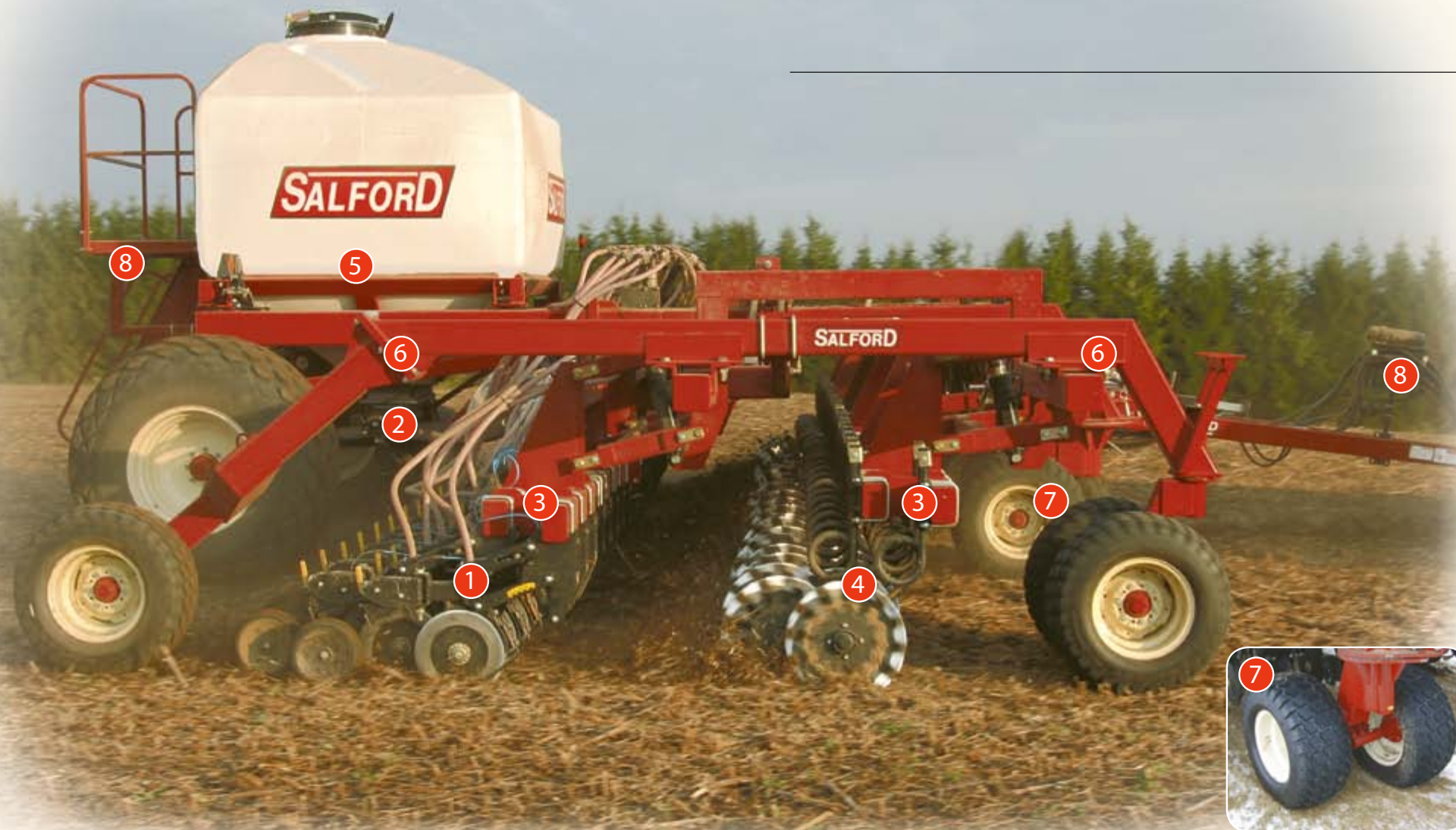
Колеса «Шагающий Тандем» на центральной раме
