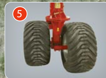
■ Колеса «Шагающий Тандем» на центральной раме
