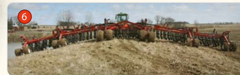
■ 525 сеялка - основные крылья 18,28 м и 21,33 м могут опускаться на 61 см и подниматься на 94 см в верхней части.
