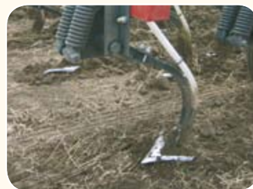
Раздельное внесение удобрений
