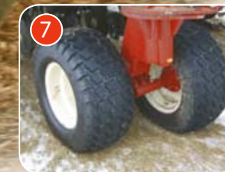
Колеса «Шагающий Тандем» на центральной раме
