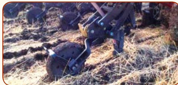
Сошник с параллелограммным механизмом SALFORD. Семенная трубка всегда сохраняет свое вертикальное положение.
