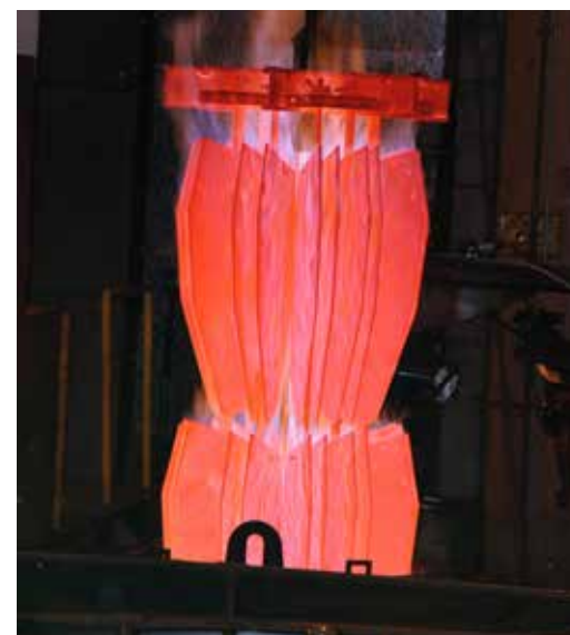
12-часовой процесс карбюризации Kverneland позволяет получить 2 структуры стали в 1 отвале: гибкая внутри для снижения нагрузки, и прочная как алмаз, снаружи для оптимальной износостойкости.
