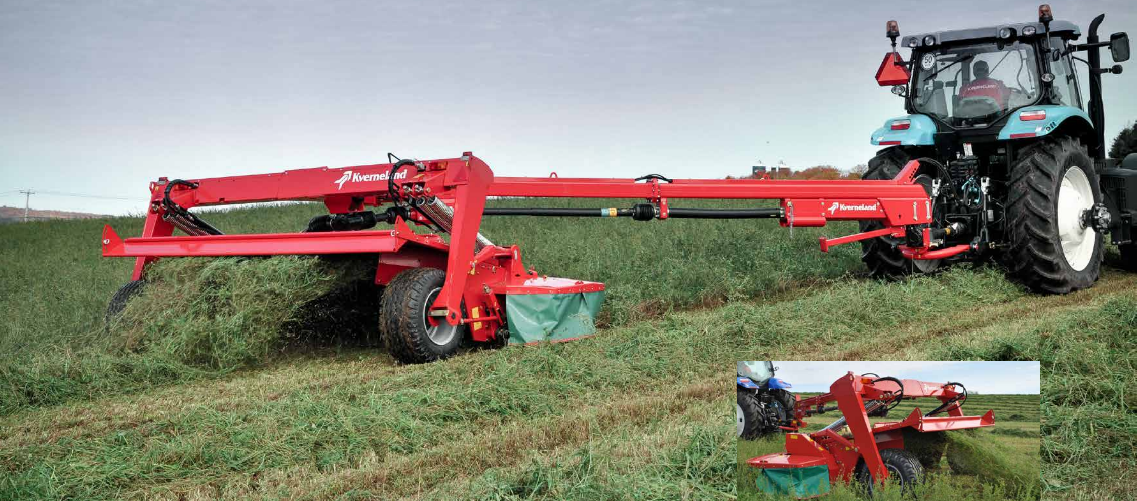
Работа с левой или с правой стороны – устанавливается из кабины трактора.
