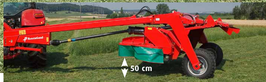
Просвет 50 см за счет конструкции тележки.
