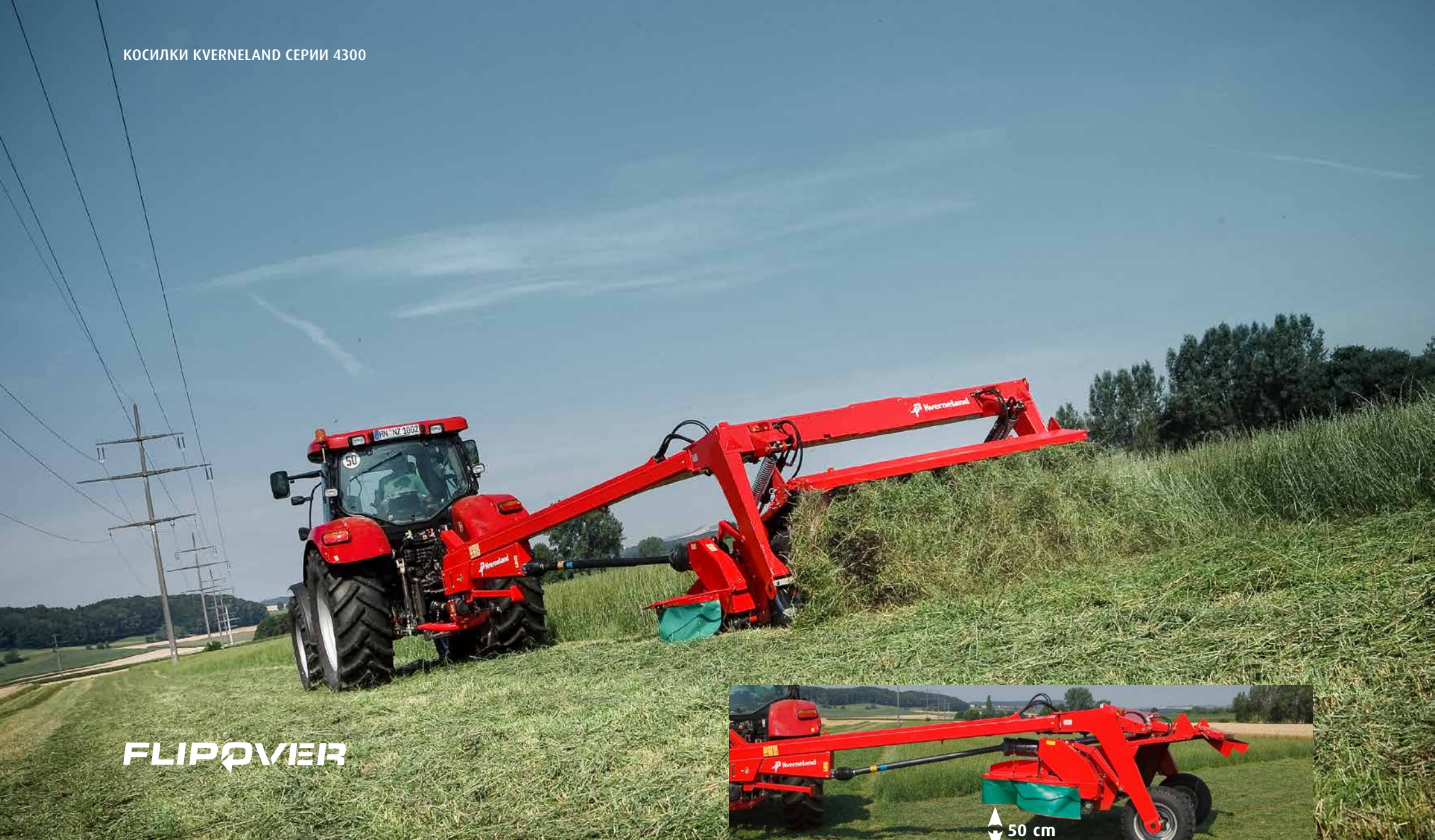
Просвет 50 см за счет конструкции тележки.
