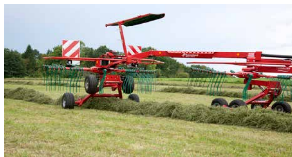
Разворот на поворотных полосах: Kverneland оснащен системой QuickLift. Это позволяет обеспечить подъем на 50 см, чтобы пересекать уложенные валки.
