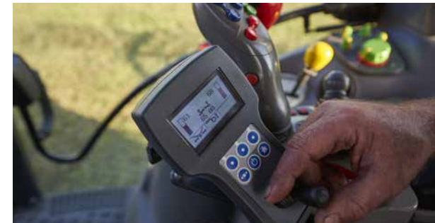
ComfortKit, включает электронное управление высотой отдельных роторов.
