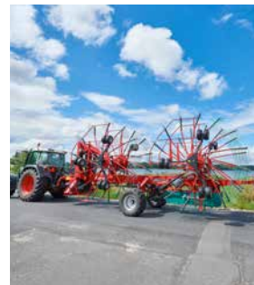
Высота при транспортировке ниже 4,0 м, даже с установленными габлинами.
