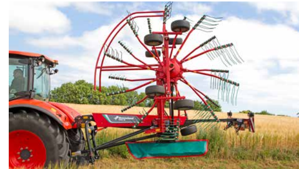
Складывание в компактное положение для транспортировки, не выходя из кабины трактора.
