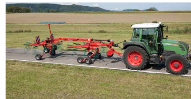
Прицепная подвеска моста обеспечивает плавную езду и снижение потребляемой мощности.
