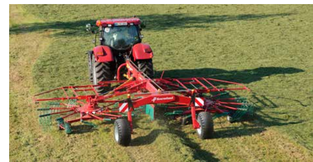
Kverneland 9584 C с шириной захвата 8,40 м, 9590 C с шириной захвата 9,00 м, полностью закрытым редуктором и гидравлически регулируемой шириной захвата.
