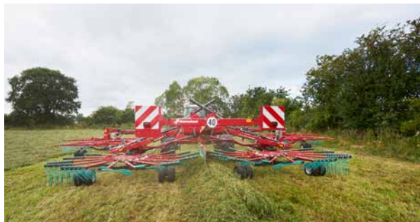
Гидравлическая регулировка ширины укладки.
