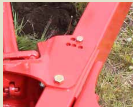
Механическая установка рабочей ширины, шаг 5 см
