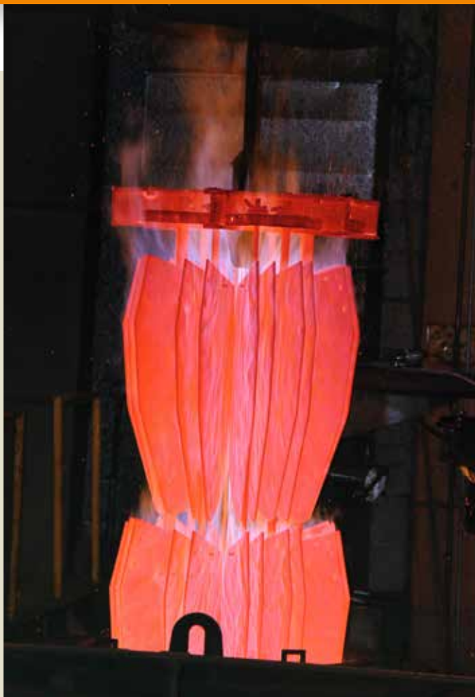
12 часов карбонизации стали для каждого отвала
