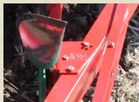
Легкая ручная регулировка ширины борозды
