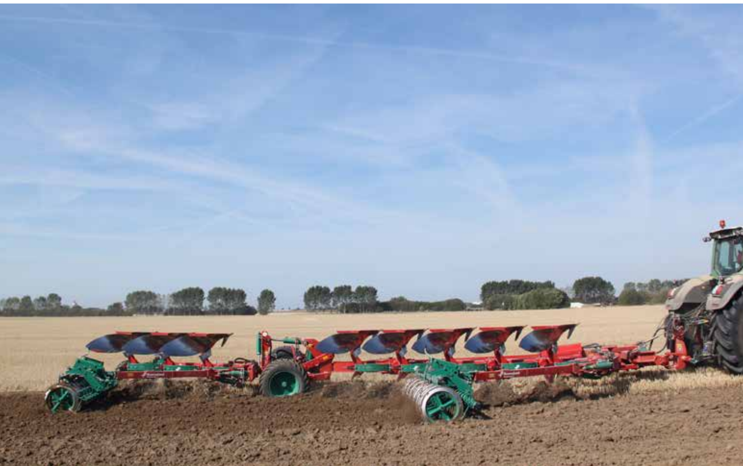
Kverneland PW Variomat® Система On-Land с Packomat. Вспашка и уплотнение за один проход.
