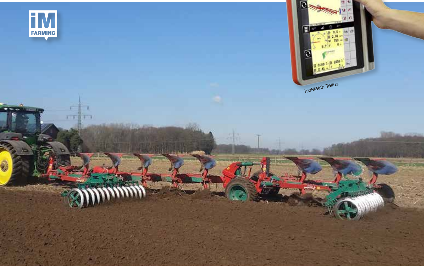
Kverneland PW Variomat@с Packomat – легкость управления с ISOBUS
