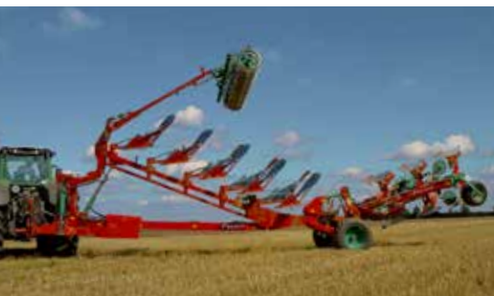
Kverneland PW Variomat® последовательность поворота
