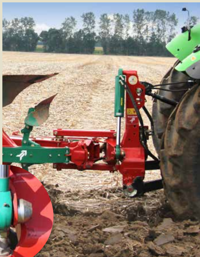
Легкая регулировка угла работы плуга через винт.
