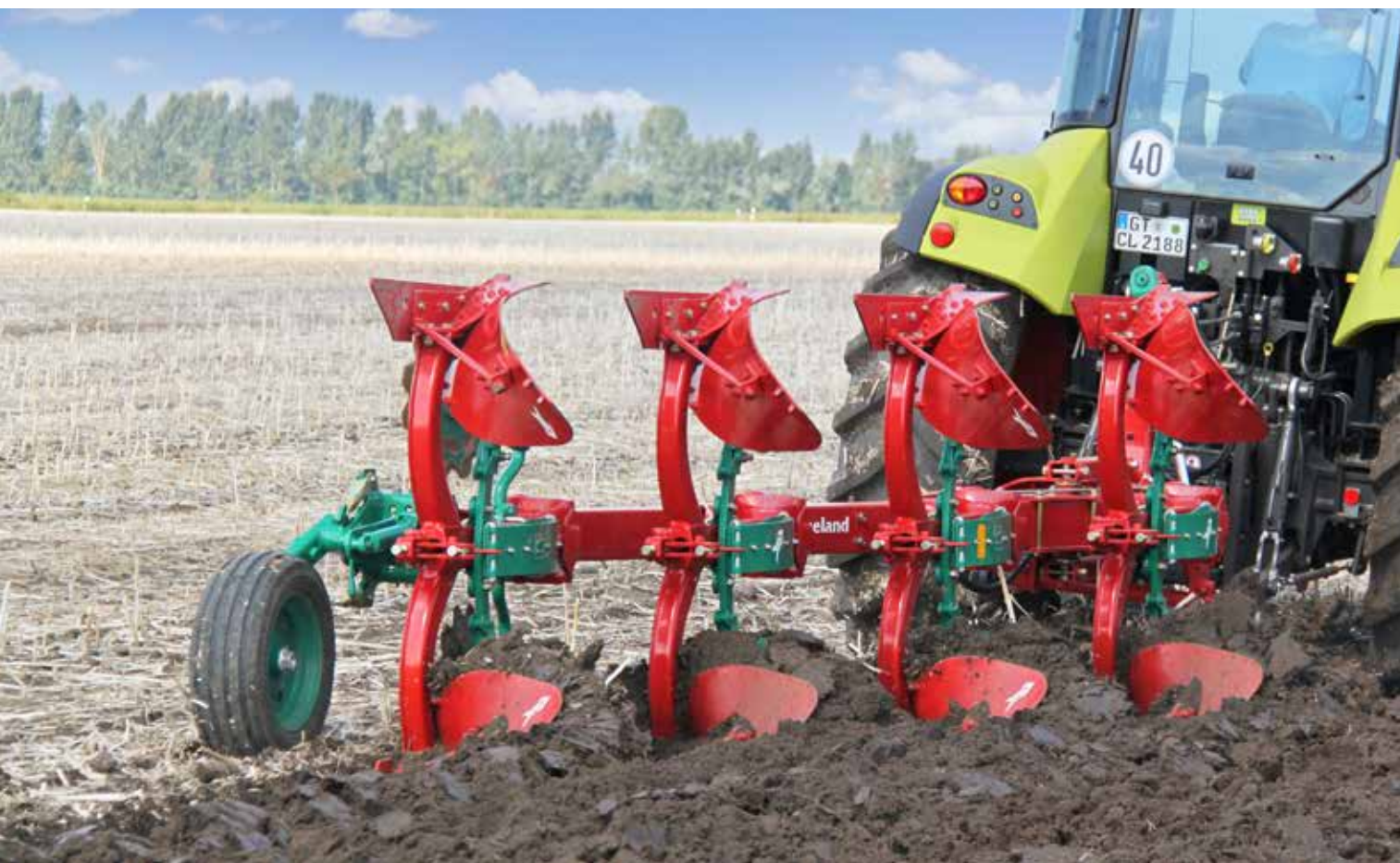
Kverneland 150 S: Система защиты Kverneland Auto-reset (S=рессорная защита)
