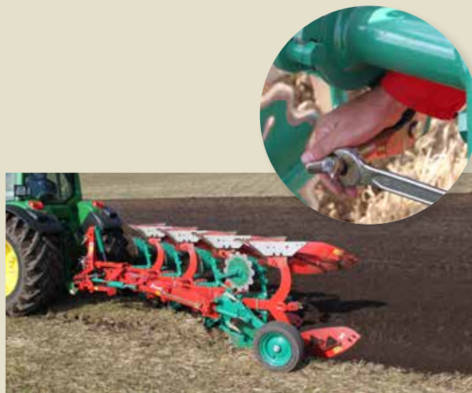
Легкая и быстрая регулировка рабочей глубины с помощью болтов Y-формы
