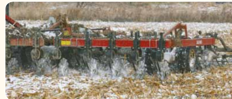
■ Работа по мерзлому грунту с I-1100
